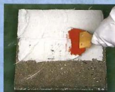
水中塗布 (水の流れが強い状態に露る。)
